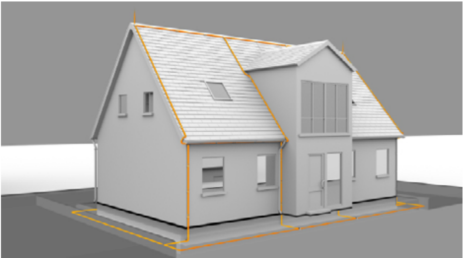
Äußere Blitzschutzanlage an einem Haus.
